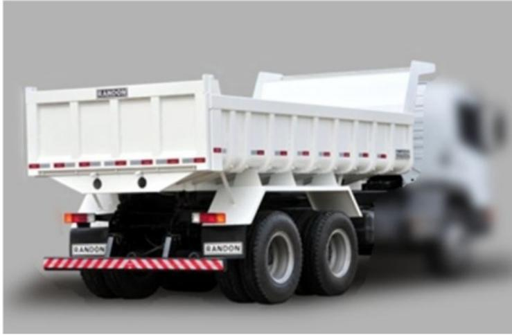
Carrocería Volquete Randon construida específicamente para el transporte de productos que permitan la descarga por volteo, con modelos adecuados la capacidad de carga para atender toda la línea de tracto camiones. Compuesta básicamente de caja de carga, sobre chasis, sistema hidráulico y accesorios.
